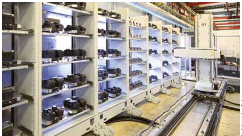
Das 11 m lange Erowa-Palettiersystem mit 110 Paletten und Portalroboter ist perfekt auf die mannlose Fertigung von Kleinstserien und Einzelteillfertigung ausgelegt.
