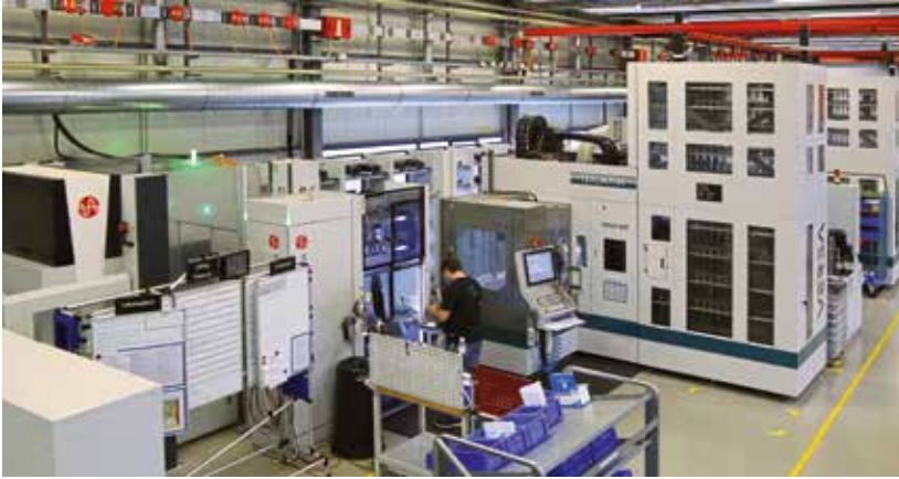
Im Bild die Fertigungsinsel mit zwei Fehlmann Versa 825, einem Erowa-Palettiersystem, einer Teilewaschanlage sowie einer Koordinatenmessmaschine für eine mannlose Rundum-die-Uhr-Bearbeitung.
