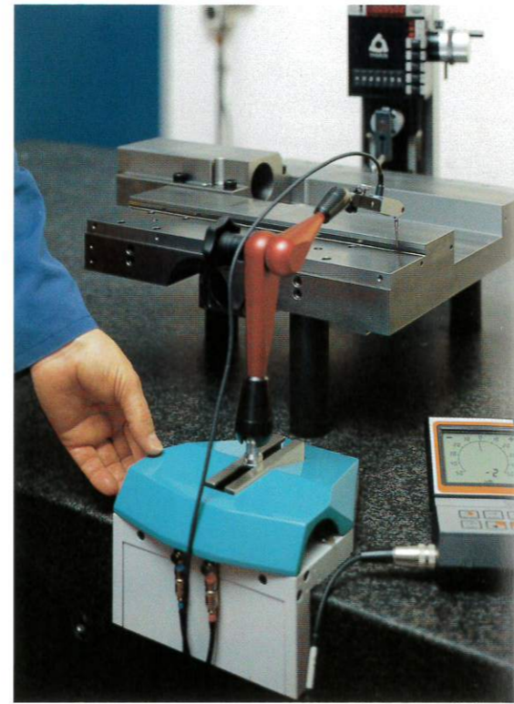
Das Messgerät „Straightline“ ermöglicht Winkel- und Ebenheitsmessungen mit höchster Messgenauigkeit.
